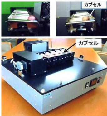
\* 試作した血液凝固検査装置\*
